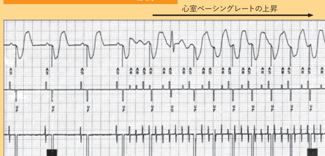
B Mode Switch ONの場合 DDDからDDIへの移行
